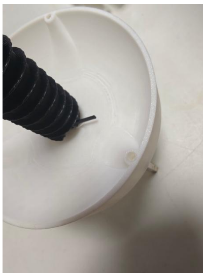
图 11 存储仓内部圆角 原型机搭建测试
